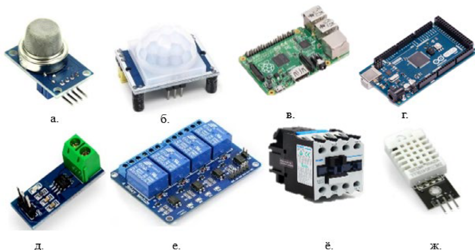
Зураг 2. а. угаарийн хий мэдрэгч б. хөдөлгөөн мэдрэгч в. Raspberry Pi г. Arduino Mega25 д. гүйдэл мэдрэгч е. реле ё. соронзон пускатель ж. температур, чийгшил мэдрэгч
