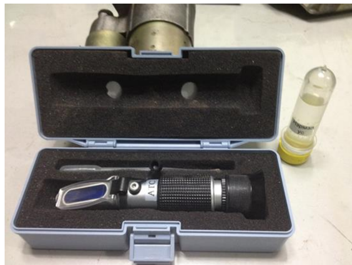
2-р зураг. Электролитийн нягтыг хэмжих YDT-4T багаж.
