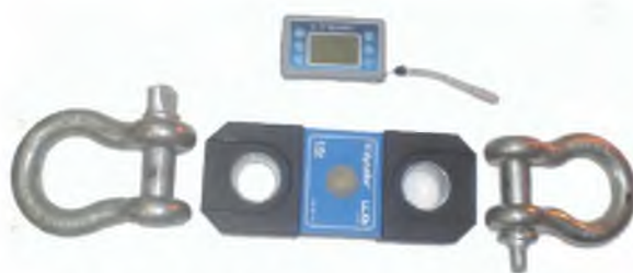
2-р зураг. Машины чангаах эсэргүүцлийг тодорхойлох DYNAFOR LLXh маркийн багаж
