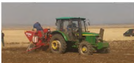
4-р зураг.Төмс үрлэх (John Deere 1204+GL410)угсрааны ерөнхий байдал
