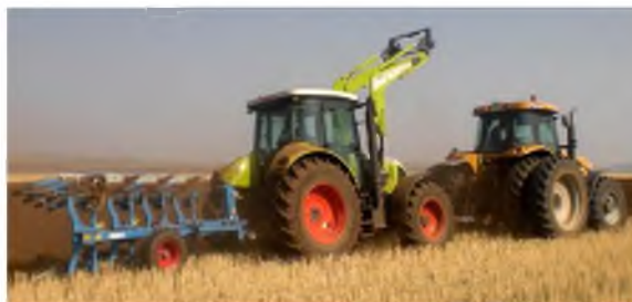
5-р зураг. Анжисны чангаах эсэргүүцлийг тодорхойлж байгаа байдал
