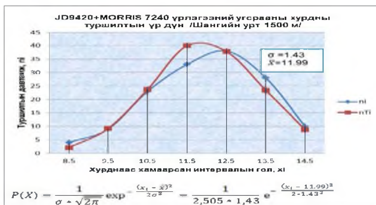
4-р зураг.Үрлэгээний угсрааны JD9420+ MORRIS 7240 угсрааны хурдны туршилтын үр дүн /Шангийн урт 1500 м /
