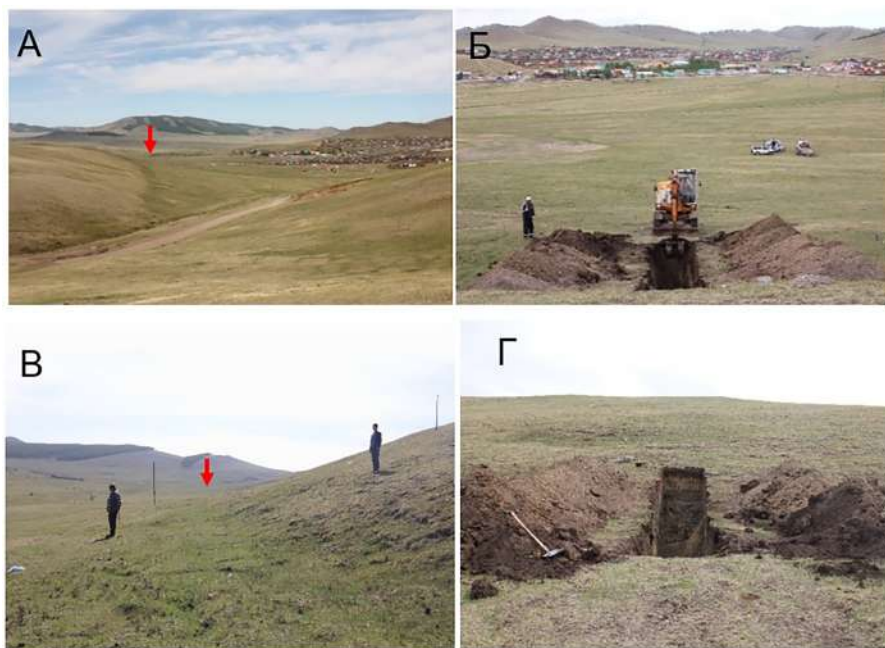
Зураг 7. Баян-Агт хагарал дээр хийсэн суваг малталт: а) Баян-Агт хагарлын мөргөцөг газрын гадарга дээр харагдах байдал. б) Экскаватороор суваг малтаж буй явц, в) Хойд зүгээс мөргөцөгийн ёроол болон доод талд хүн зогсоосон. г) Малтсан сувгуудын хойд зүгээс харагдах байдал, тод улаан сумаар хагарлын байрлал болон мөргөцөгийг тэмдэглэв. Сувгийн дундаж хэмжээ: гүн \sim 2.5 м, өргөн -1м, урт- 12м.
